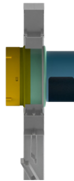
루버용 환기캡 설치 상태
